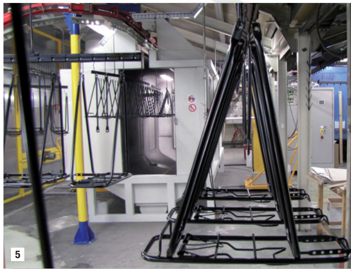
5 Porta bicicletas entram na cabine de aplicação de pó.
